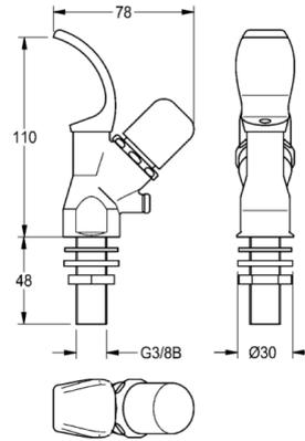
Selbstschluss-Trinkbrunnenarmatur DN 15, mit Kappendruckknopf und Verdrehsicherung, Messing poliert verchromt. Anschluss G 3/8 B.
